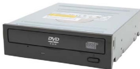
ภาพที่ 3.52 คอมโบไดรฟ์ (Combo Drive)
