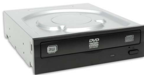
ภาพที่ 3.53 ดีวีดีไรท์เตอร์ (DVD ReWriter)
