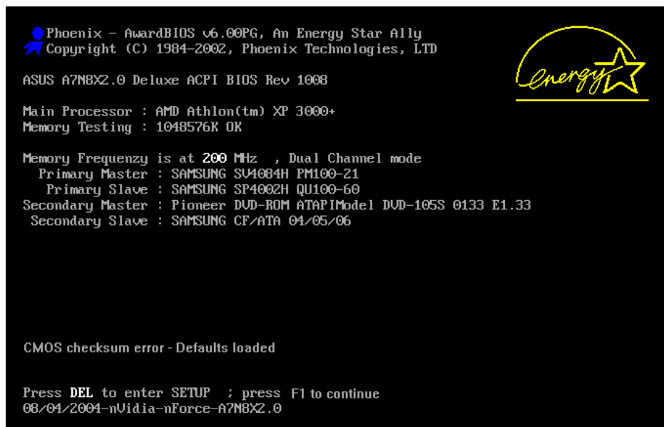
ภาพที่ 13.1 ภาพหน้าจอแสดงผลกระบวนการตรวจสอบฮาร์ดแวร์ของไบออส
