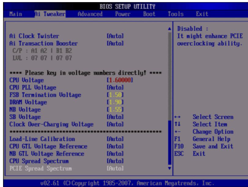
ภาพที่ 13.6 ตัวอย่างตำแหน่งการกำหนดแรงดันให้กับซีพียู
