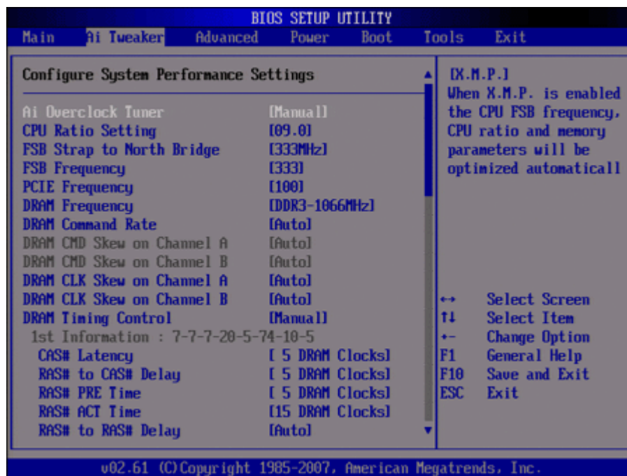
ภาพที่ 13.5 ตัวอย่างตำแหน่งการโอเวอร์คล็อกในไบออส
