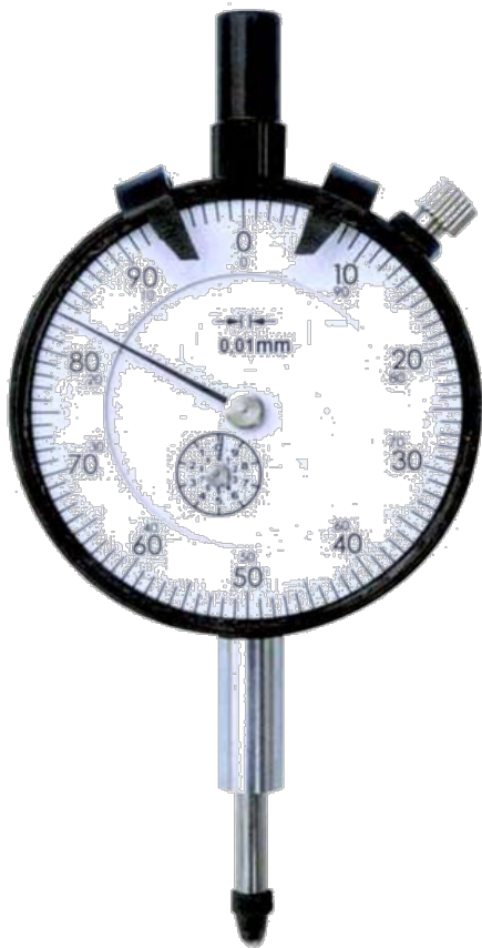
ภาพที่ 6.1 แสดงลักษณะของนาฬิกาการวัดชนิดมาตรฐาน
