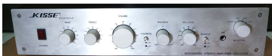
รูปที่ 5.1 หน้าปัดด้านหน้า ของอินทิเกรตแอมพลิไฟเออร์ ที่ใช้ในการแข่งขันทักษะอาชีพ ปี 2559
