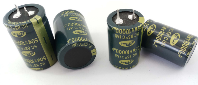
รูปที่ 2.18 ตัวอย่างคาปาซิเตอร์ฟิเตอร์ที่ใช้ในวงจรเพาเวอร์ซัพพลาย
