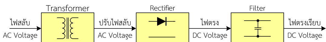
รูปที่ 2.7 บล็อกไดอะแกรมแหล่งจ่ายไฟตรงแบบใช้คาปาซิเตอร์เป็นตัวกรองพร้อมสัญลักษณ์
