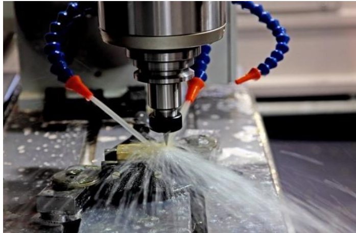
รูปที่ 7.15 แสดงการใช้คำสั่ง M08 เป็นคำสั่งเปิดน้ำหล่อเย็น (ที่มา : http://www.bandaprecisionengineering.co.uk )
