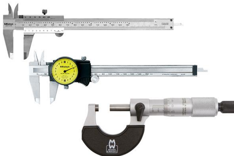
รูปที่ 7.48 แสดงเครื่องมือวัดและตรวจสอบงานกัดพื้นฐาน (ที่มา : https://www.wonkeedonkeetools.co.uk )
