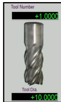
รูปที่ 7.25 แสดงการกำหนดหมายเลขเครื่องมือตัดและขนาดเส้นผ่านศูนย์กลางทูล (ที่มา : ฉัตรชัย สมพงศ์. 2559)
