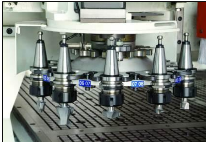
รูปที่ 7.44 แสดงชุดอุปกรณ์จัดเก็บเครื่องมือตัดชนิดจานหมุนเปลี่ยนอัตโนมัติ (Carousel Type Tools Magazine) (ที่มา : http://www.kutenich.com )
