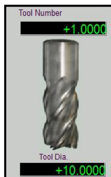
รูปที่ 7.39 แสดงการกำหนดหมายเลขเครื่องมือตัดและขนาดเส้นผ่านศูนย์กลางทูล
