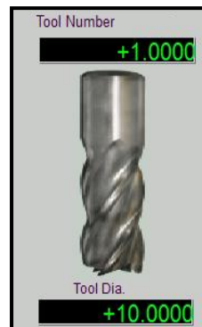
รูปที่ 7.31 แสดงการกำหนดหมายเลขเครื่องมือตัดและขนาดเส้นผ่านศูนย์กลางทูล (ที่มา : ฉัตรชัย สมพงษ์. 2559)
