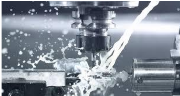
รูปที่ 3.40 แสดงการใช้สารหล่อเย็นในการตัดเฉือนชิ้นงาน
