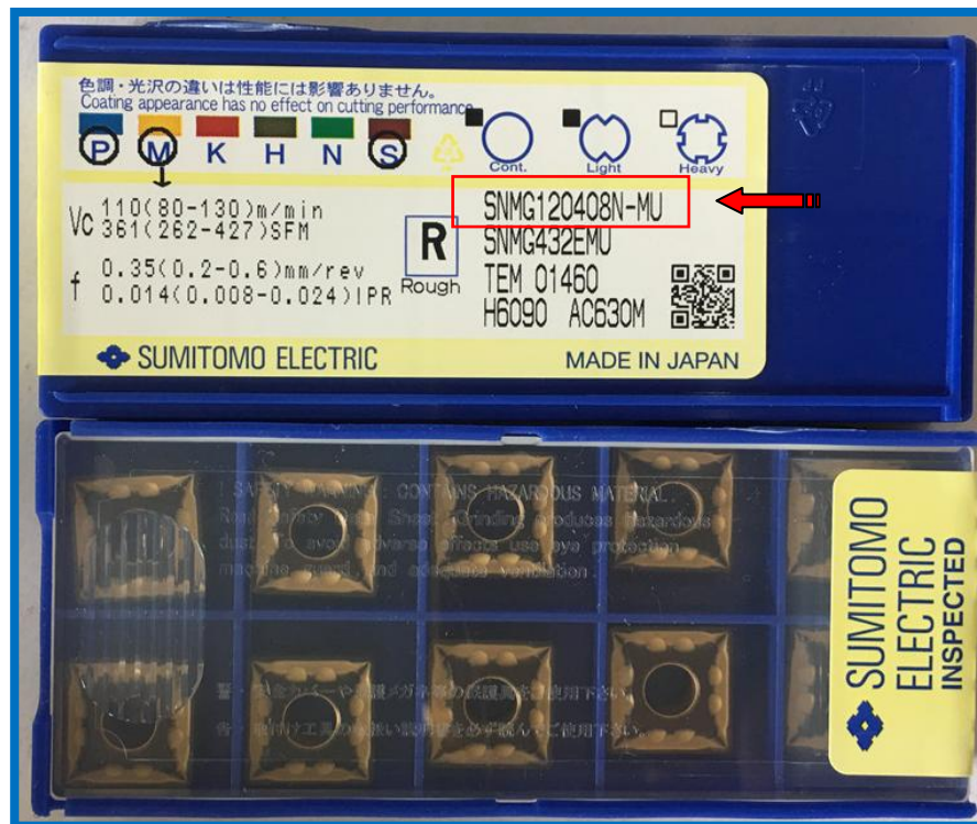
รูปที่ 3.34 แสดงรหัสเม็ดมีดอินเสิร์ตบนกล่องบรรจุเม็ดมีดอินเสิร์ตSUMITOMO (ที่มา : https://www.aliexpress.com )
