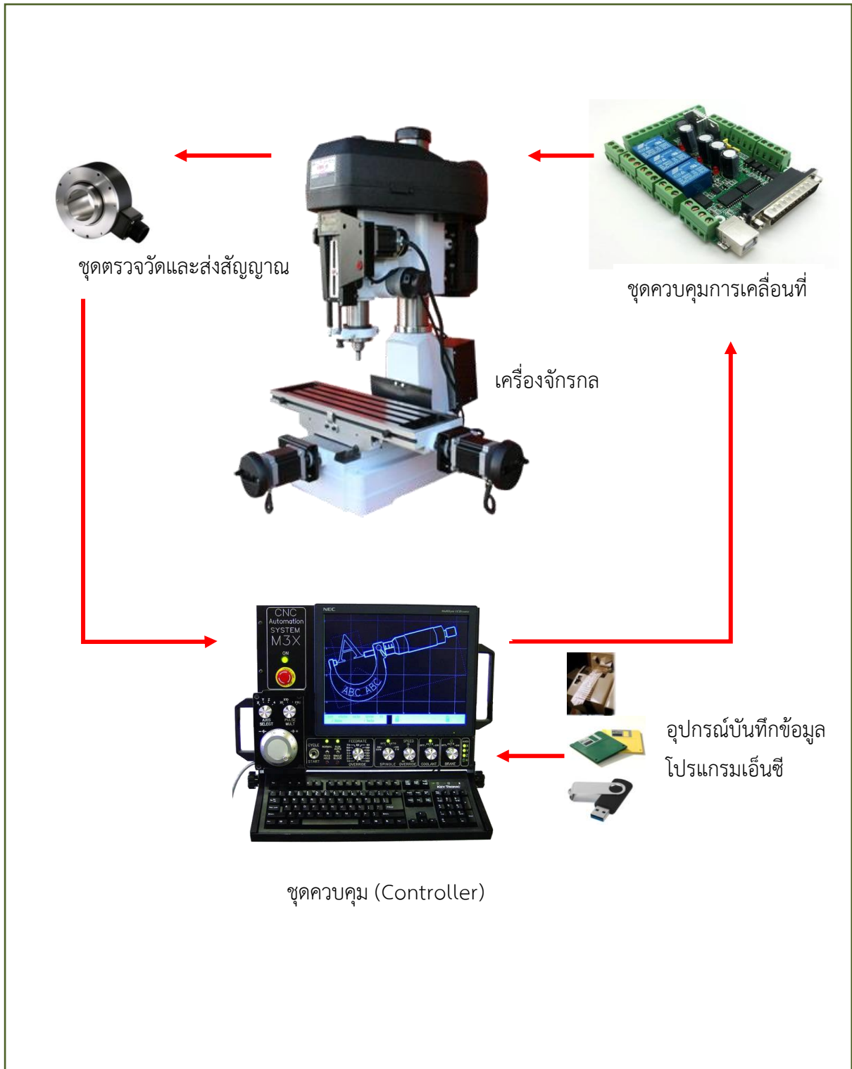
รูปที่ 1.3 แสดงหลักการทำงานของเครื่องจักรกลซีเอ็นซี (ที่มา : ฉัตรชัย สมพงศ์. 2559)
