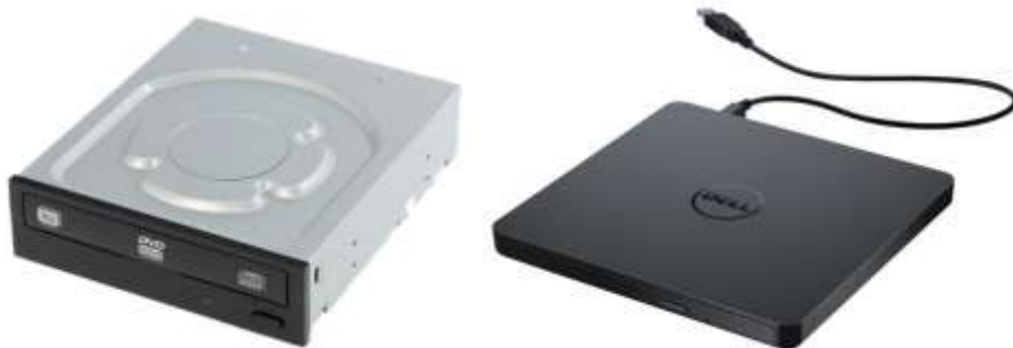
ภาพที่ 8.16 ออปติคอลไดรฟ์แบบติดตั้งภายใน และแบบติดตั้งภายนอก
