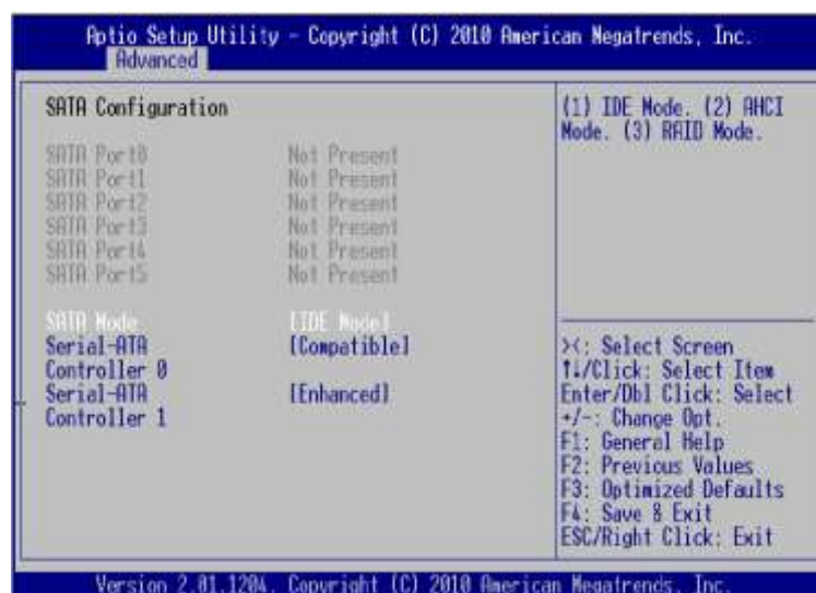
ภาพที่ 6.9 เมนู SATA Configuration ของไบออสยี่ห้อ AMI
