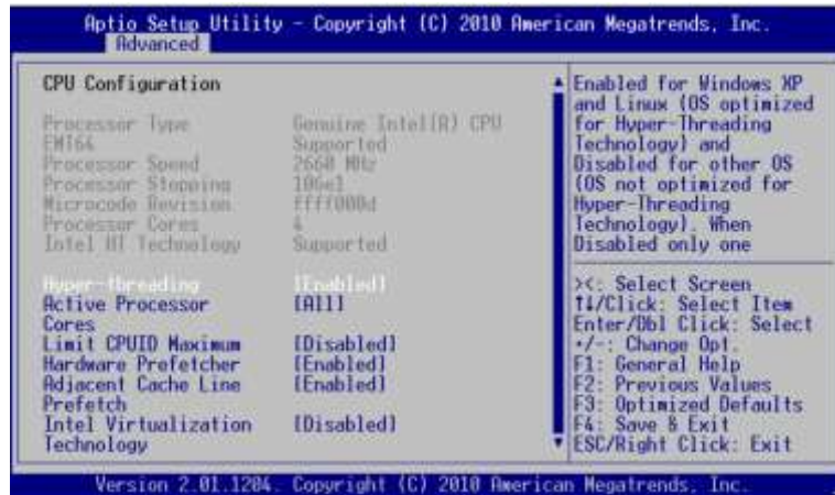
ภาพที่ 6.8 เมนู CPU Configuration ของไบออสยี่ห้อ AMI
