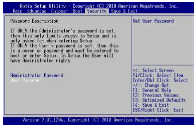
ภาพที่ 6.13 เมนู Security ของไบออสยี่ห้อ AMI
