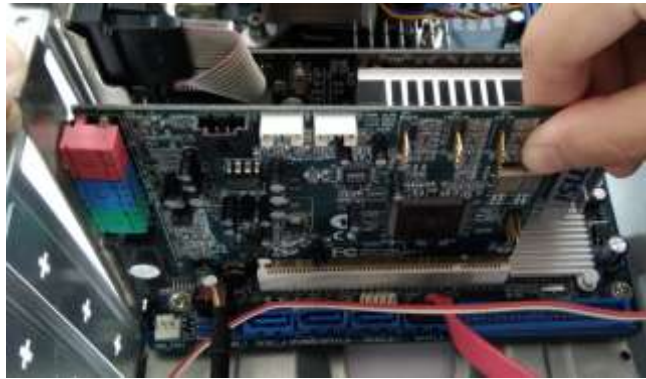
ภาพที่ 5.26 การติดตั้งการ์ดเสียง
