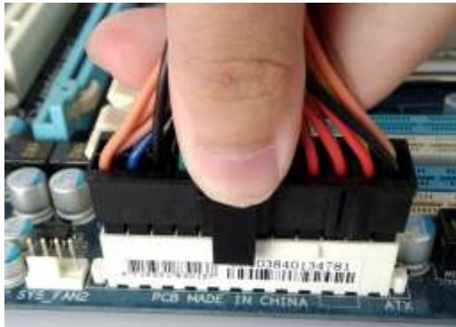
ภาพที่ 5.28 การติดตั้งจุดจ่ายไฟหลักให้กับเมนบอร์ด
