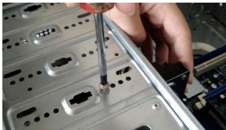
ภาพที่ 5.17 การติดตั้งฮาร์ดดิสก์ลงในเคส
