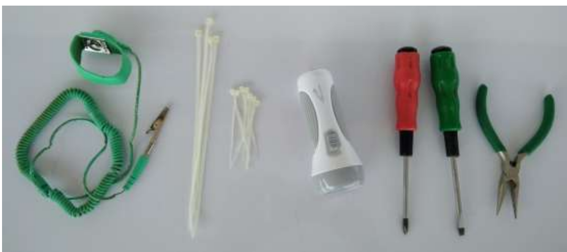
ภาพที่ 5.1 เครื่องมือที่ใช้ในการประกอบคอมพิวเตอร์
