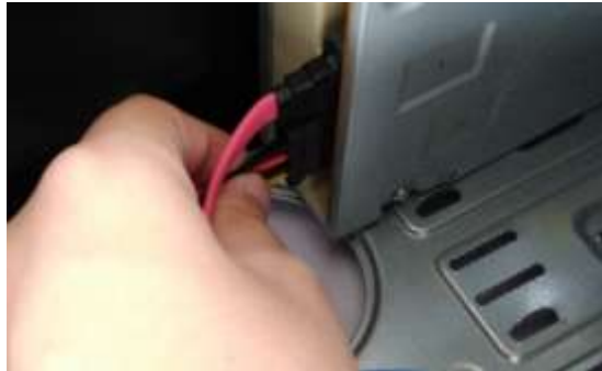
ภาพที่ 5.31 การติดตั้งจุดจ่ายไฟให้กับอุปกรณ์ออปติคอลไดร์ฟ
