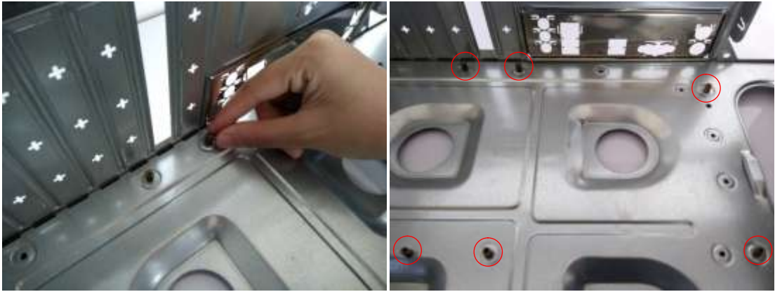
ภาพที่ 5.7 การติดตั้งเสารองเมนบอร์ดบนแท่นรองเมนบอร์ด
