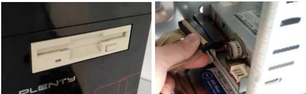
ภาพที่ 5.23 การติดตั้งฟลอปปีดิสก์ไดรฟ์
