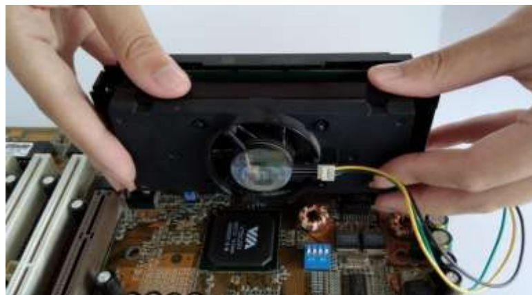
ภาพที่ 5.10 การติดตั้งซีพียูเป็นแบบคาร์ทริดจ์ (Cartridge)
