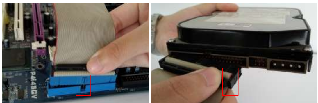
ภาพที่ 5.19 การติดตั้งสายแพบนเมนบอร์ด และฮาร์ดดิสก์
