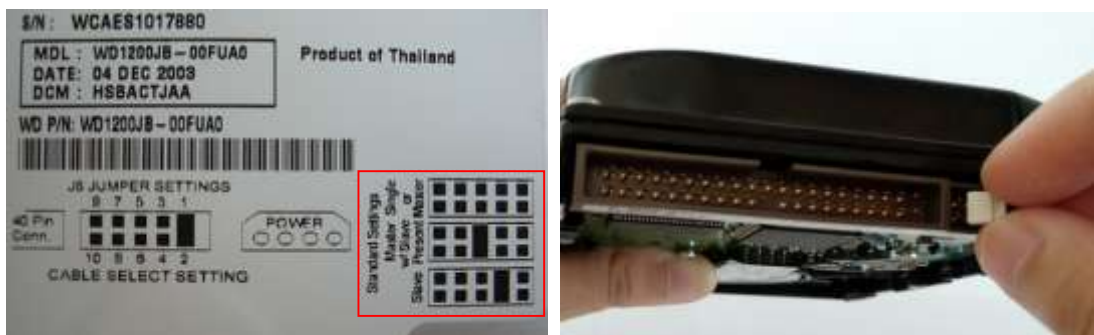
ภาพที่ 5.18 การกำหนดค่าให้อุปกรณ์ไอดีอี ให้เป็นอุปกรณ์หลัก (Master) และอุปกรณ์รอง (Slave) ที่มา : https://www.zive.cz/poradna/vadny-hdd/sc-20-cq-396993/default.aspx?consultanswers=1,2559
