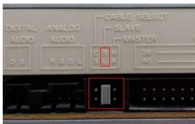
ภาพที่ 5.21 การกำหนดให้อุปกรณ์ออปติคอลไดรฟ์แบบไอดีอีเป็นอุปกรณ์รอง ( Slave )
