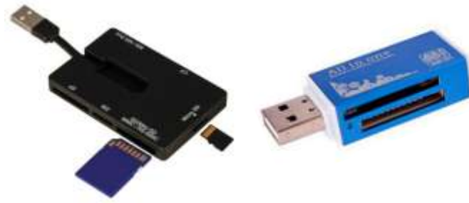
ภาพที่ 3.58 เครื่องอ่านการ์ดหน่วยความจำแบบภายนอก
