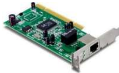
ภาพที่ 3.59 การ์ดเครือข่ายติดตั้งภายในแบบใช้สาย
