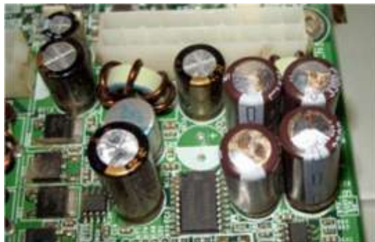
ภาพที่ 14.5 ตัวเก็บประจุบนเมนบอร์ดที่มีลักษณะปูดบวม
