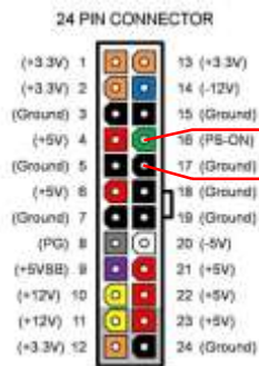
ภาพที่ 14.3 ตำแหน่งการลัดวงจร (Short) หัวต่อแบบเอทีเอ็กซ์ (ATX)
