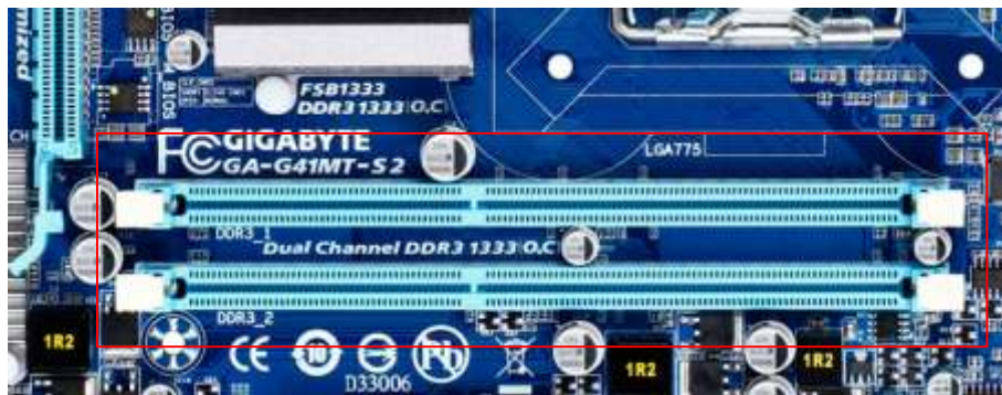
ภาพที่ 11.3 สล็อตแรมบนเมนบอร์ดที่รองรับแรมดีดิวอาร์ 3 (DDR3) บัส 1333 MHz ที่มา : https://www.gigabyte.com/th/Motherboard/GA-G41MT-S2-rev-15#ov,2559
