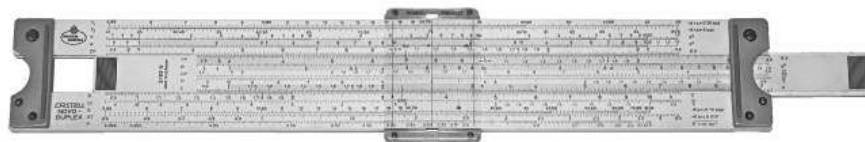
ภาพที่ 1.8 ไม้บรรทัดคำนวณ (Slide Rule) ที่มา : http://chalkdustmagazine.com/features/slide-rules-early-calculators/ , 2559
