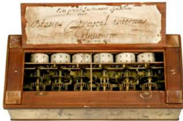
ภาพที่ 1.5 เครื่องคำนวณปาสคาลไลน์ (Pascaline) ที่ใช้กลไกเฟืองของไบลส์ ปาสคาล
