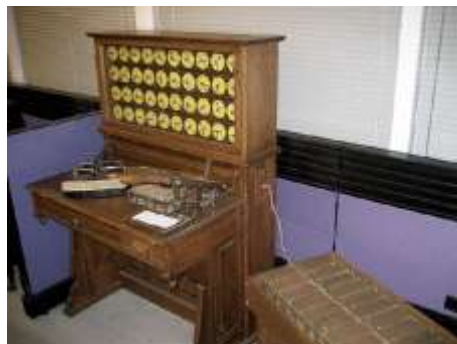
ภาพที่ 1.13 เครื่องประมวลผลทางสถิติซึ่งใช้กับบัตรเจาะรู
