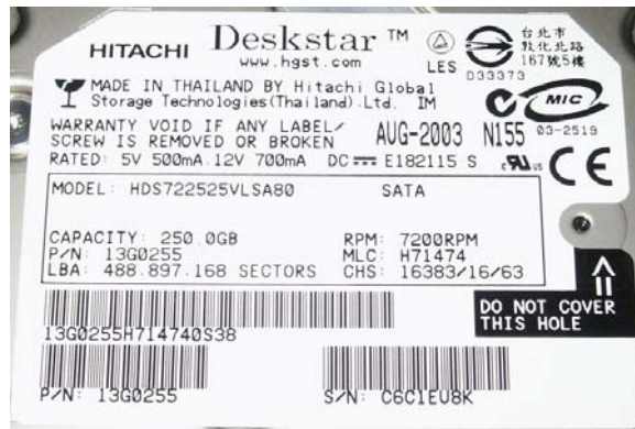
ภาพที่ 8.11 ตัวอย่างฉลากรายละเอียดของฮาร์ดดิสก์
