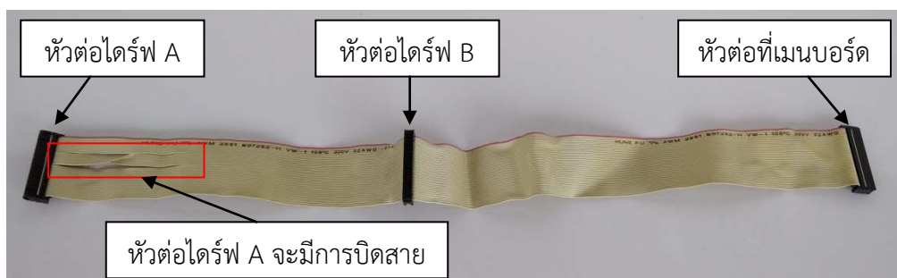
ภาพที่ 5.22 สายสัญญาณสำหรับเชื่อมต่อฟลอปปีดิสก์ไดรฟ์
