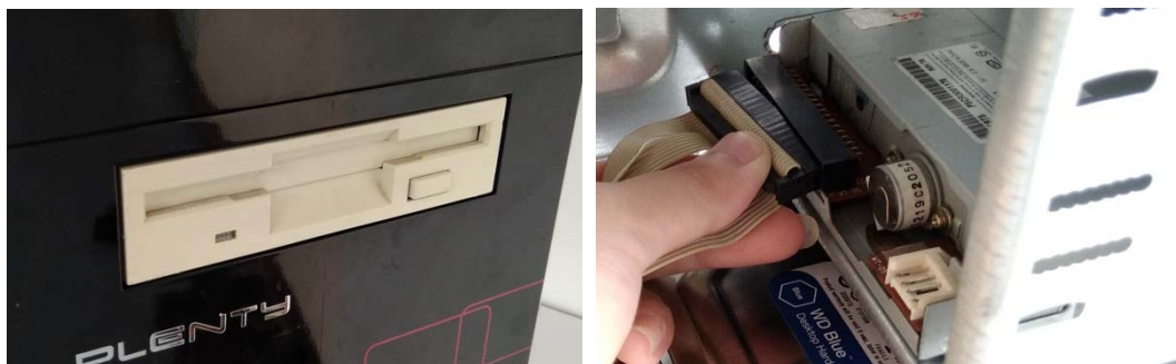
ภาพที่ 5.23 การติดตั้งฟลอปปีดิสก์ไดรฟ์
