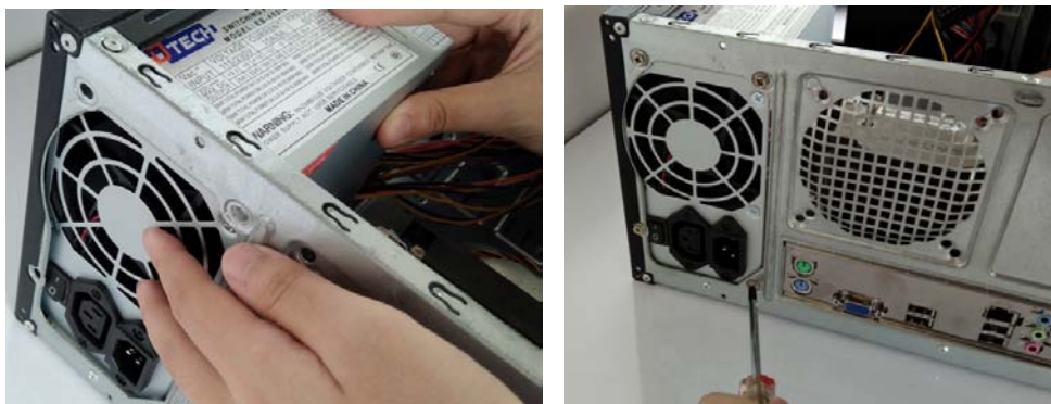
ภาพที่ 5.27 การติดตั้งแหล่งจ่ายไฟ
