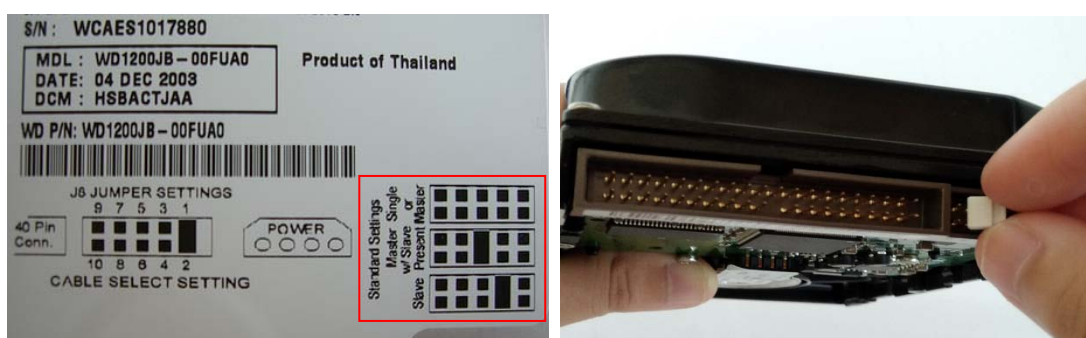
ภาพที่ 5.18 การกำหนดค่าให้อุปกรณ์ไอดีอี ให้เป็นอุปกรณ์หลัก (Master) และอุปกรณ์รอง (Slave) ที่มา : https://www.zive.cz/poradna/vadny-hdd/sc-20-cq-396993/default.aspx?consultanswers=1,2559
