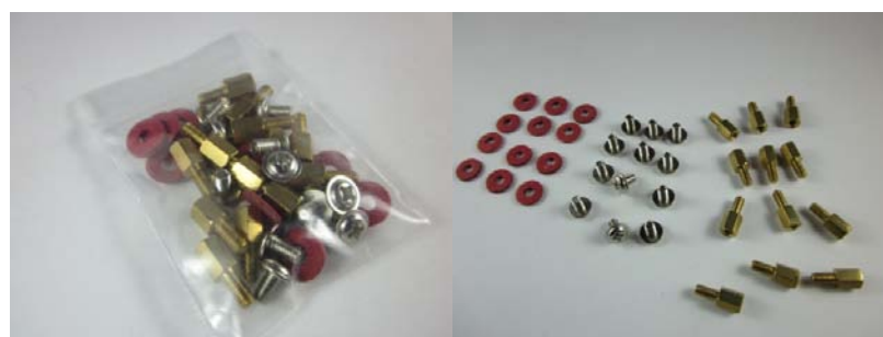
ภาพที่ 5.4 ชุดสกรู แหวนรอง และเสาทองเหลืองสำหรับยึดเมนบอร์ดที่ให้มาพร้อมเคส
