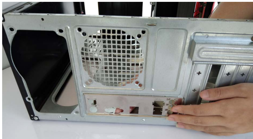
ภาพที่ 5.6 การติดตั้งแผ่นเพลทที่ให้มาพร้อมกับเมนบอร์ด
