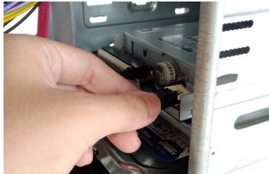
ภาพที่ 5.32 การติดตั้งจุดจ่ายไฟให้กับฟล็อปปี้ดิสก์ไดรฟ์
