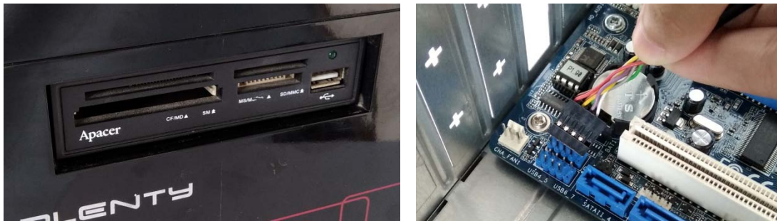
ภาพที่ 5.24 การติดตั้งเครื่องอ่านการ์ดหน่วยความจำ
