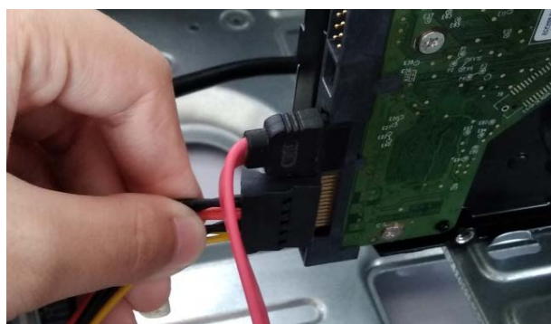
ภาพที่ 5.30 การติดตั้งจุดจ่ายไฟให้กับฮาร์ดดิสก์
