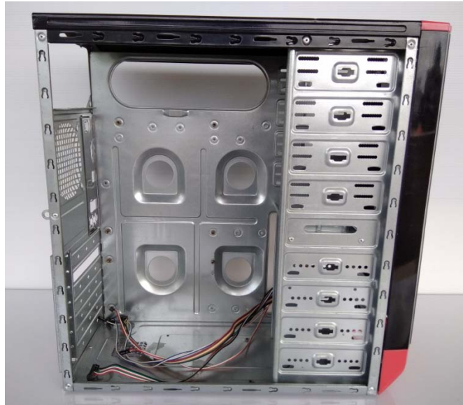
ภาพที่ 5.5 ภาพเคสที่ถูกถอดฝาออกทั้ง 2 ข้าง
