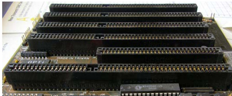
ภาพที่ 4.14 สล็อตไอเอสเอ หรือ ไอซ่า (ISA)
