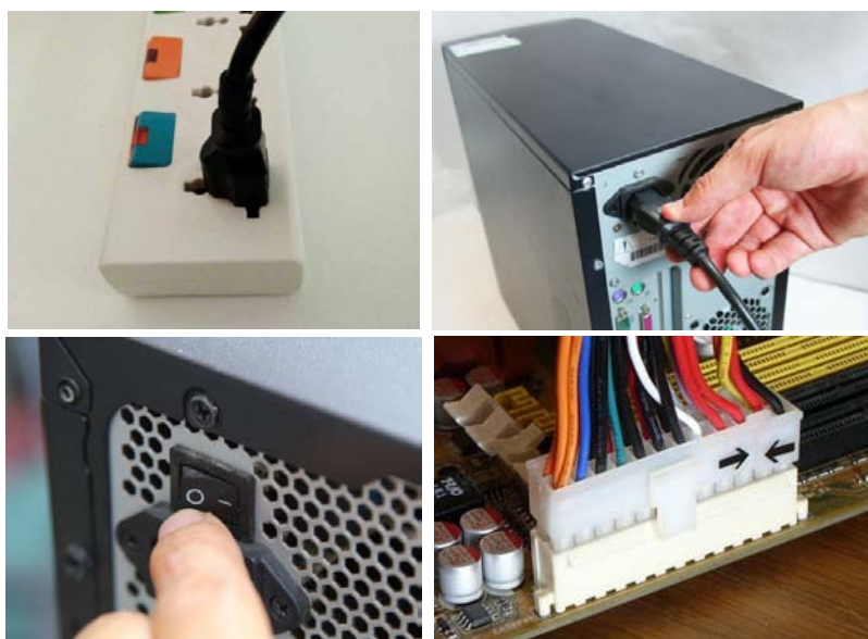
ภาพที่ 14.2 จุดตรวจสอบการจ่ายไฟให้กับเครื่องคอมพิวเตอร์
