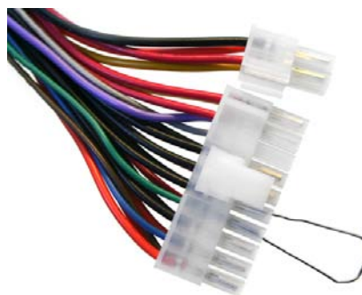
ภาพที่ 14.3 ตำแหน่งการลัดวงจร (Short) หัวต่อแบบเอทีเอ็กซ์ (ATX)
