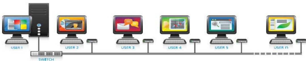
ภาพที่ 1.33 ผังการเชื่อมต่อระบบ อิน โคลเอ็นท์ (Thin Client)
