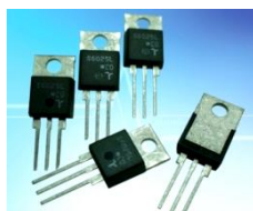
รูปที่ 8.19 แสดงรูปร่างควอแดรก ที่มา (www.plextron.com.tw., 2559)
