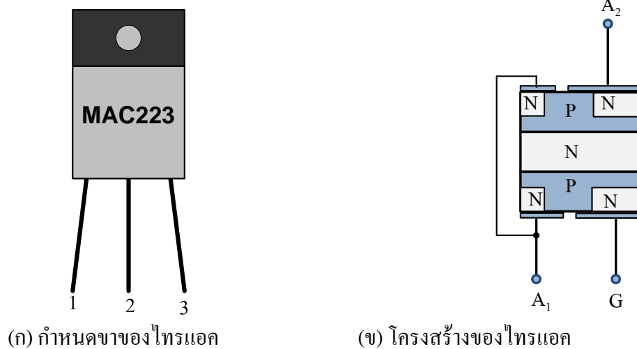
รูปที่ 8.22 แสดงการกำหนดขาและโครงสร้างของไตรแอก
