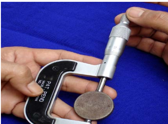
รูปที่ 5.25 ตรวจสอบสเกลศูนย์ที่ก้านสเกล ที่มา : ณรงค์ อองอาจ ;2555
