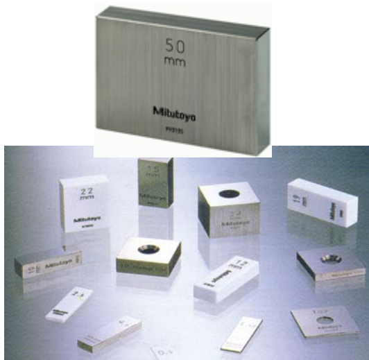
รูปที่ 5.22 การตรวจสอบกับแท่งมาตรฐาน
