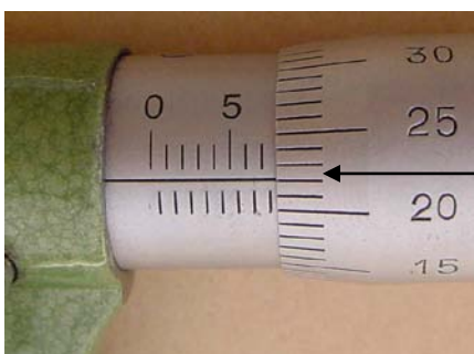
รูปที่ 5.15 ขีดสเกลที่ปลอกหมุนวัด
