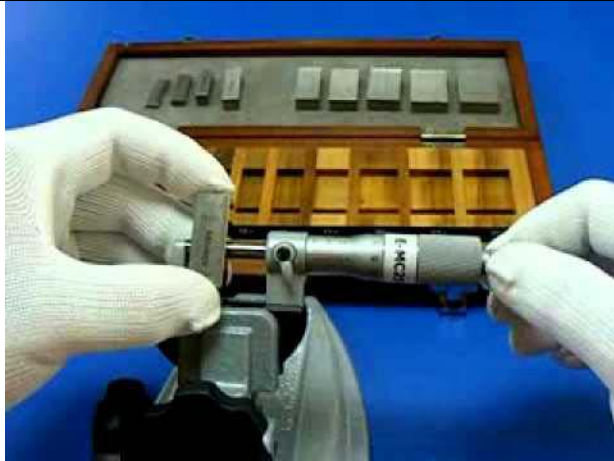
รูปที่ 5.22 การตรวจสอบกับแท่งมาตรฐาน
