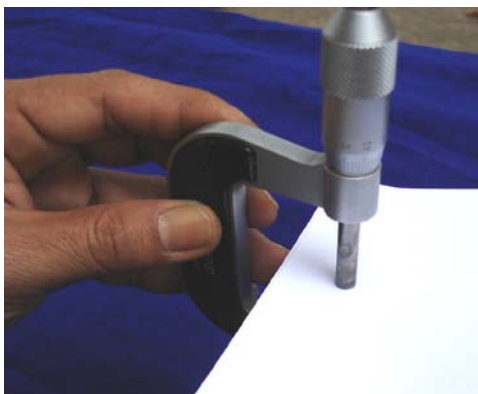
รูปที่ 5.24 ทำความสะอาดแกนวัดไมโครมิเตอร์
