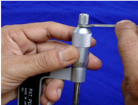
รูปที่ 5.25 ตรวจสอบสเกลศูนย์ที่ก้านสเกล ที่มา : ณรงค์ อองอาจ ;2555
