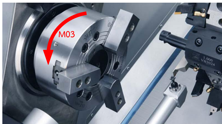
รูปที่ 8.9 แสดงคำสั่ง M03 สั่งให้เพลาสปินเดิลหมุนทิศทางตามเข็มนาฬิกา (มองจากด้านหลังเพลาสปินเดิล) (ที่มา : https://www.haascnc.com )
