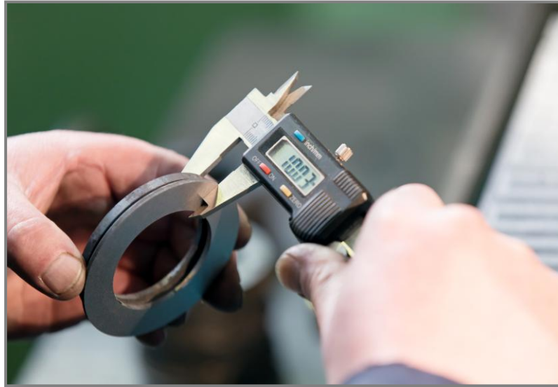
รูปที่ 8.38 แสดงการใช้เวอร์เนียคาลิเปอร์เพื่อตรวจสอบขนาดชิ้นงานกลึง
