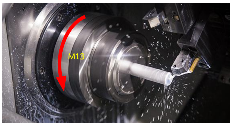
รูปที่ 8.12 แสดงคำสั่ง M13 สั่งให้เพลาสปินเดิลหมุนทิศทางตามเข็มนาฬิกาพร้อมเปิดน้ำหล่อเย็น (ที่มา : https://www.protolabs.com )
