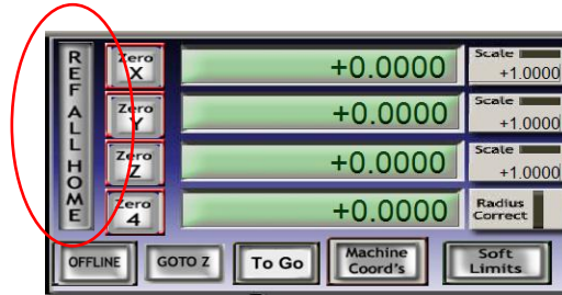
รูปที่ 5.14 แสดงปุ่มใช้งาน Reference All Home ของชุดควบคุม Mach3 Mill
