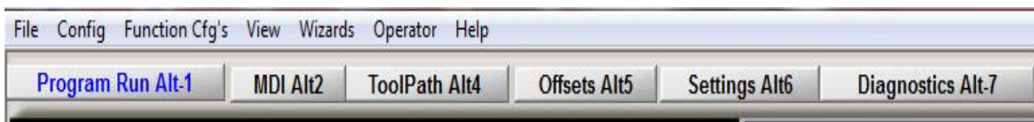
รูปที่ 5.3 แสดงโหมดการใช้งานของชุดควบคุม Mach3 Mill (ที่มา : ฉัตรชัย สมพงษ์. 2559)
