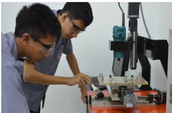
รูปที่ 5.49 แสดงการทำความสะอาดบริเวณแกนบอลล์สกรู
