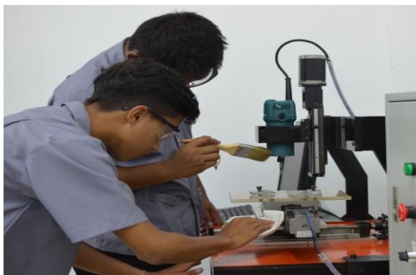
รูปที่ 5.47 แสดงการทำความสะอาดบริเวณเพลาสปินเดิลและหัวจับเครื่องมือตัด (ที่มา : ฉัตรชัย สมพงษ์. 2559)
